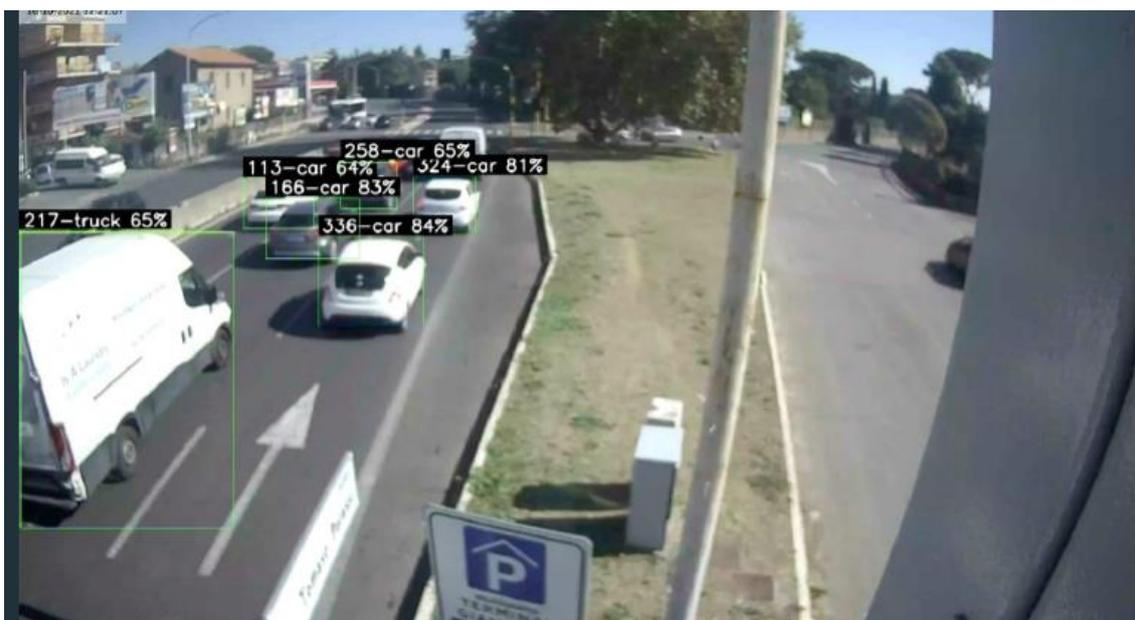
La tecnologia di Video analisi con AI dispone di una serie di modelli di Intelligenza Artificiale essenziali per il rilevamento di anomalie ed eventi che riguardano la circolazione. In particolare, è in grado di rilevare:
